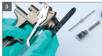
Enfin dévisser la buse de peinture à l'aide de la clé polygonale intégrée dans l'outil universel.
