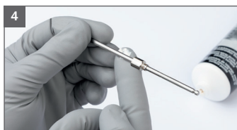
Graisser l'aiguille de peinture autour du joint de l'aiguille
