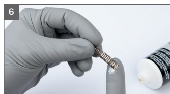
Graisser et installer le ressort de l'aiguille de peinture
