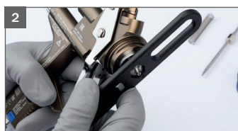
Serrer manuellement la buse de peinture à l'aide de la clé universelle
