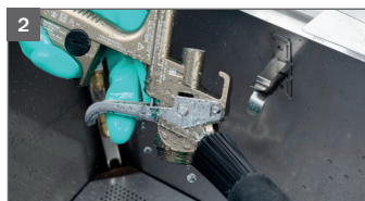
Nettoyage du corps du pistolet
