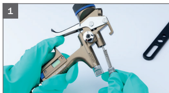
Lors du nettoyage du pistolet, retirer d'abord l'aiguille de peinture.
