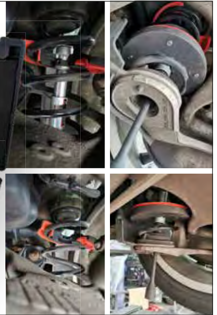
500.8765 Jeu de compresseurs de ressorts télescopiques pour ressorts intérieurs pour Audi et Seat
