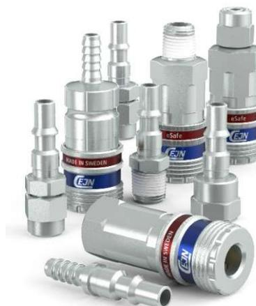
La série 291 eSafe offre un haut débit et nécessite une faible force de connexion, qui assure un environnement de travail sûr. eSafe est un raccord sûr, connectable d'une main, à décompression, éliminant le risque de coup de fouet. Les filetages mâles des coupleurs et embouts sont munis d'un produit d'étanchéité pré-appliqué. Un fonctionnement quasi automatique assure une manipulation rapide et facile. eSafe est conforme à la norme ISO 4414 EN 983.
